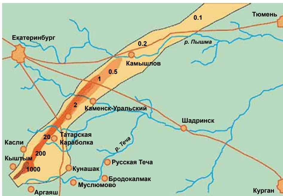
Рис. 2.49. Территория Восточно-Уральского радиоактивного следа (цифрами указаны плотности загрязнения почвы ^{90}\text{Sr} в Ки/км 2 )
