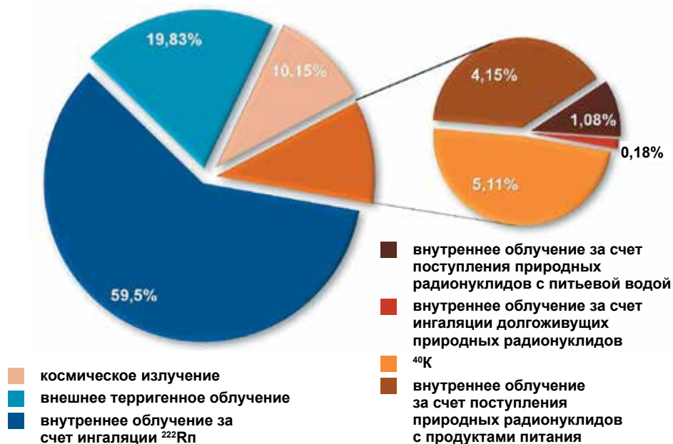
Рис. 1.6. Вклад отдельных источников излучения в суммарные дозы облучения населения за счет природных источников излучения [99]
